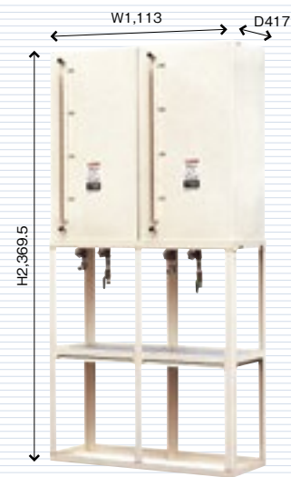
□2連式ウォールタンク(3/4ボールバルブ付) 容積：248ℓ×2 容量：230ℓ×2 重量：225.3kg
