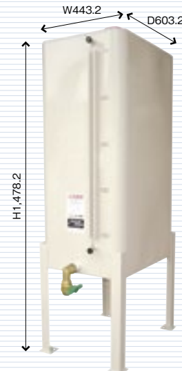
□250角型(1インチバルブ付) 容積：273ℓ 容量：250ℓ 重量：45kg
