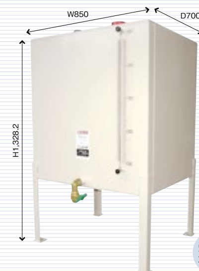
□500角型圧送式(1インチバルブ付) 容積：527ℓ 容量：500ℓ 重量：85kg
